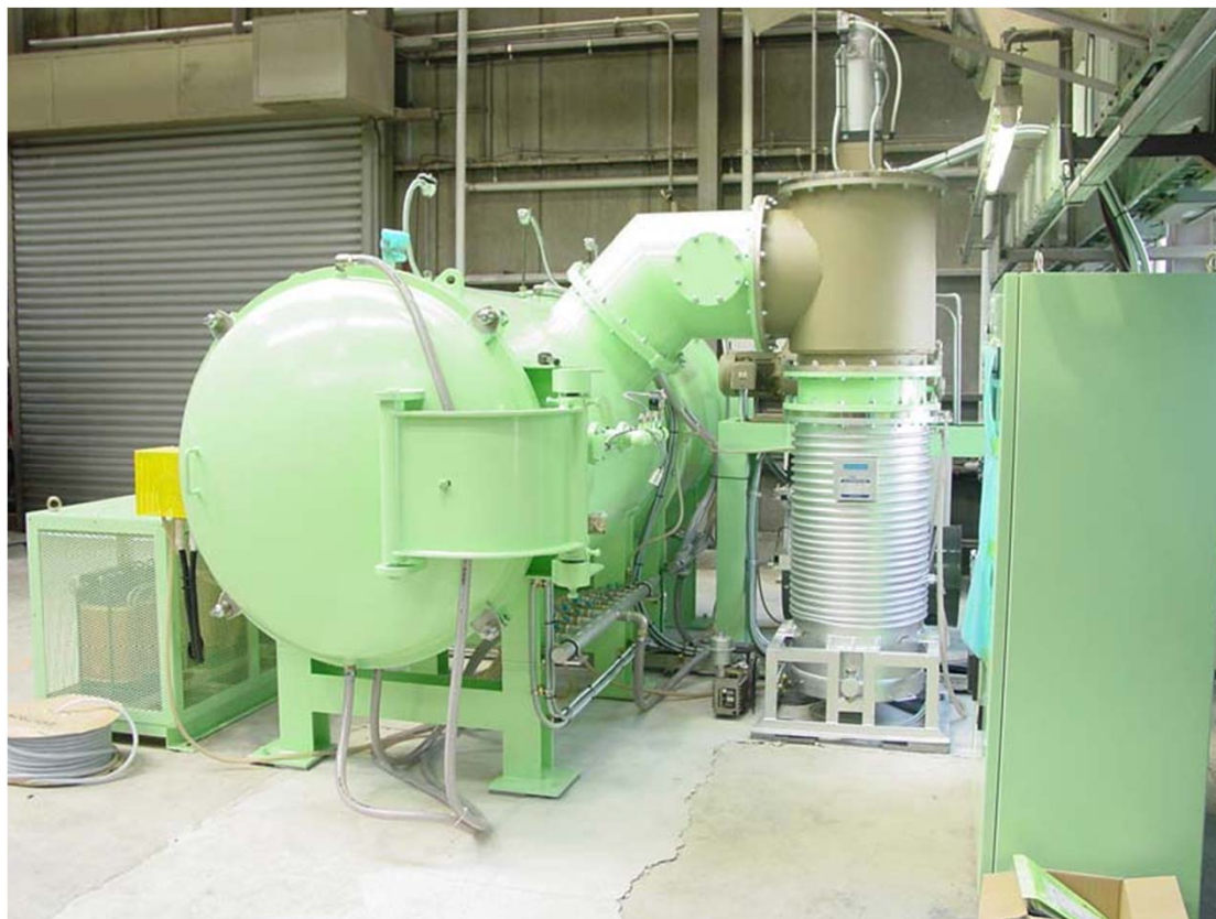
大型真空炉(KEK機械工作センター) 仕様: 800°C, ~E-6 Torr, Working zone 500 \phi x 3000L
